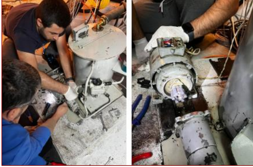
Şekil 41. RTT150 Teleskobu Yağ Motorunun Bakımları.
